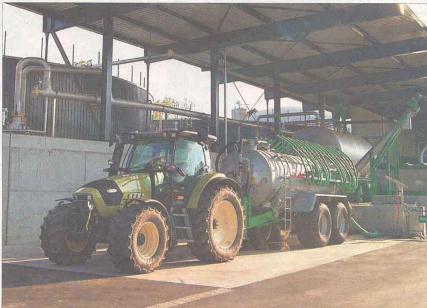
Mit den anfallenden 20 000 Kubikmetern Flüssigdünger aus der Biogasanlage werden 2000 ha Landwirtschaftsland gedüngt. Die Bauern bezahlen nur den Transport und das Ausbringen. (Bild Ruth Aerni)
