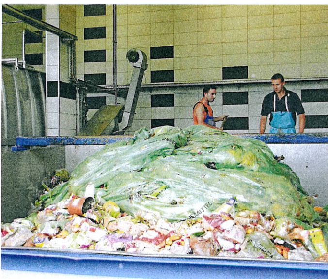
Täglich werden rund 30 t Lebensmittel in die Biogasanlage angeliefert und dort zu Biogas und Biogülle aufbereitet und vergärt.
