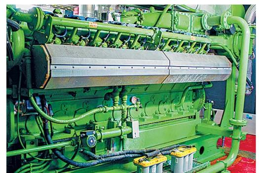
Blockheiz-Kraftwerk zur Stromerzeugung aus Biogas.
